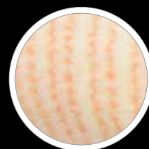
Pinselartig zersplissenes Polyamid-Endlosgarn
